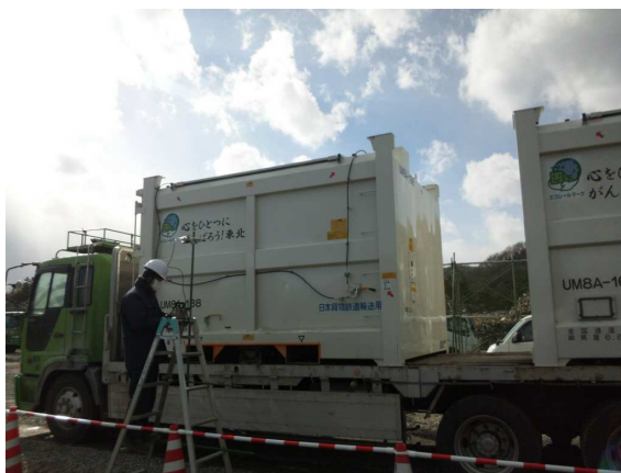
【宮古市藤原埠頭における東京向けガレキの放射能測定作業の様子】
