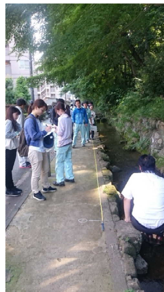
湧水の流量測定（浮き流し法）
