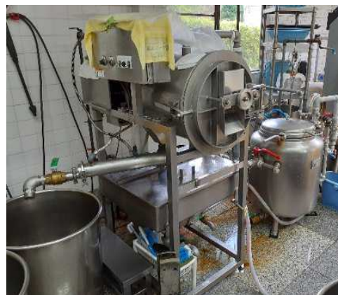
■ 豆腐製造機械（左：磨碎，右：加熱～分離～凝固）
