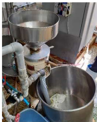
■ 豆腐製造機械（左：磨碎，右：加熱～分離～凝固）
