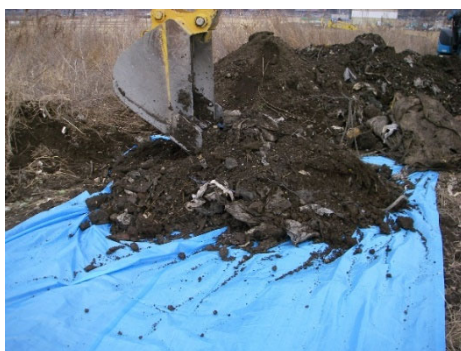
写真 6 埋設廃棄物試料採取状況
